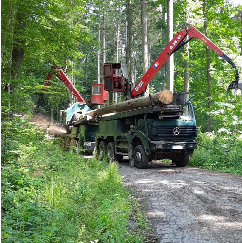
Abb. 3: Die Arbeitsvorgänge während der Entrindung. Der auf den ersten LKW aufgelagerte Stamm wird auf dem zweiten LKW von Vorschubwalzen aufgenommen und anschließend entrindet. (Foto Forstamt)
