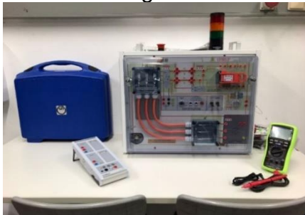
Abb. 14: KFZ-Hochvolttrainer (System- und Hochvolttechnik) für die Ehrhart-Schott-Schule Schwetzingen
