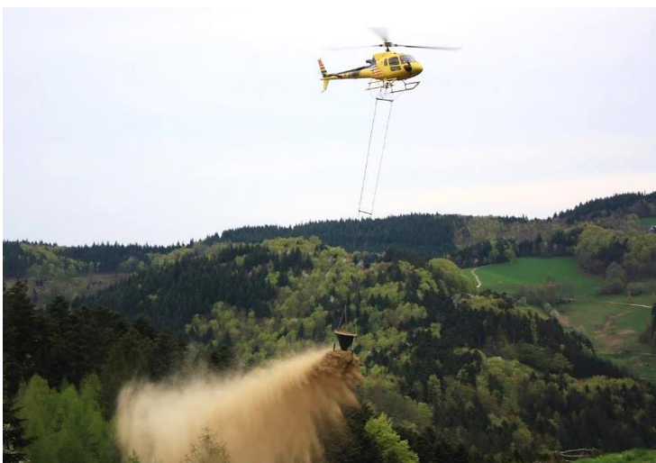
Abb. 4 Ausbringung von Kalk per Helikopter. Foto von Helix Fluggesellschaft mbH
